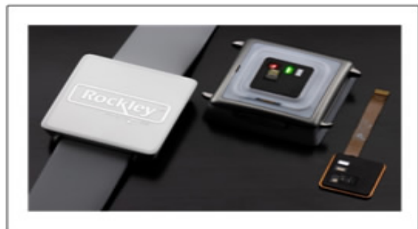
(d) Rockley Photonics 血糖监测芯片 [113] (d) Blood glucose monitoring chip from Rockley Photonics [113]
